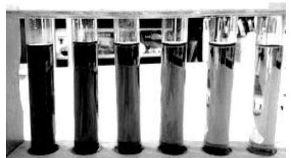
Figure 4 : Gamme étalon des 6 solutions de diiode
